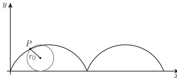
Ein Kreis mit Radius  $r_0$  rollt in der  $xy$ -Ebene auf der  $x$ -Achse. Zu einem gewissen Zeitpunkt  $t = 0$  koinzidiere der Nullpunkt  $(x, y) = (0, 0)$  mit einem Punkt  $P$  auf dem Kreis, der durch den Bahnvektor  $\vec{r}(t) = (x(t), y(t))$  beschrieben wird.
