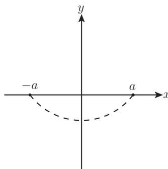
Ein Seil der Länge  $L$  und einer Masse  $m$  sei an zwei Punkten  $(-a, 0)$  und  $(a, 0)$  befestigt. Bestimmen Sie nun, welchen Verlauf das Seil  $y(x)$  unter Einfluss der Schwerkraft beschreibt. Dies bedeutet, dass Sie die Funktion  $y(x)$  bestimmen müssen, unter welcher die potentielle Energie
