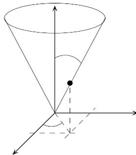
Ein Partikelchen der Masse  $m$  gleitet reibungsfrei auf der Innenseite eines Kreiskegels. Die Gravitationskraft wirke in die negative  $z$ -Richtung und der Winkel  $\alpha$  zwischen der  $z$ -Achse und der Kegeloberfläche sei konstant.
