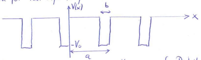
$V_0 \cdot b = \text{konstant}$ ,  $V_0 \rightarrow \infty \rightarrow$  Kamm von  $\delta$ -Distributionen
