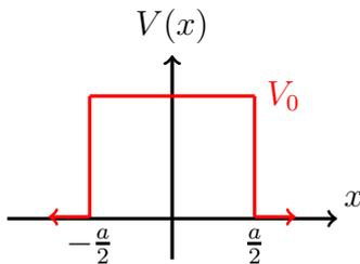
$$V(x) = \begin{cases} 0 & \text{für } |x| \geq \frac{a}{2} \\ V_0 & \text{für } |x| < \frac{a}{2} \end{cases}$$
