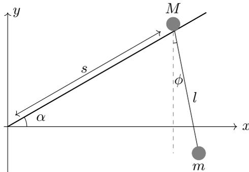
1. Wie lautet die Lagrange-Funktion  $L(\phi, s, \dot{\phi}, \dot{s})$ ?
