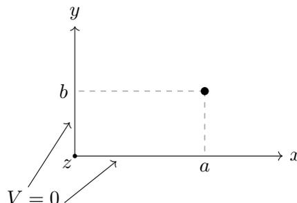
Zwei geerdete Halbebenen schließen einen Winkel  $90^\circ$  miteinander ein. Eine Halbebene sei die  $xz$ -Ebene mit  $x > 0$ . Die andere sei dann die  $yz$ -Ebene mit  $y > 0$ . Die Ebenen treffen sich also in der  $z$ -Achse. Eine Punktladung  $q$  befindet sich an dem Punkt  $\mathbf{r}$  in Zylinderkoordinaten  $(\rho_0, \phi_0, 0)$ .
