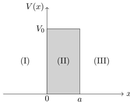
Betrachten Sie eine kastenförmige Potentialbarriere der Höhe  $V_0$ . Das Ziel: Die Berechnung der stationären Zustände eines Teilchens der Energie  $E < V_0$ , welches sich auf die Barriere zubewegt und die Bestimmung dadurch den Transmissionskoeffizienten  $t = t(E)$ .
